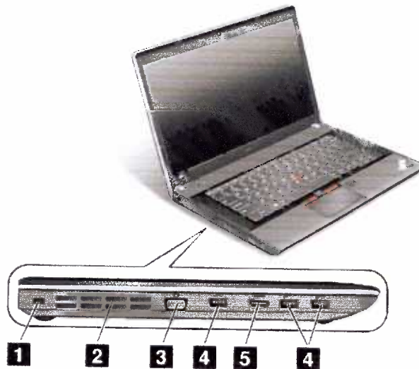
Figura 4. Vista lateral esquerda do ThinkPad Edge E430, E430c, E435, E530, E530c e E535
